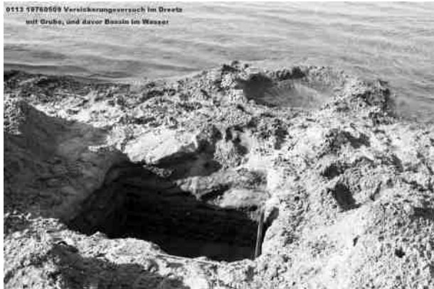
0113 19780509 Versickerungsversuch im Dreetz mit Grube, und davor Basalt im Wasser 1971 Barby'scher Versickerungsversuch am Dreetzufer (vorne Grube im Uferbereich, dahinter eingedeichter, kleiner Seebereich als Becken)
