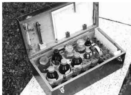
**Wasserkasten von Bergmann & Altmann für einfache Untersuchungen O<sub>2</sub>-nach Hofer/Geyer, pH-Cz u.strip, SBV**
