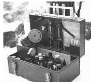
**Von BONITO stark verbesserter Wasserkasten O<sub>2</sub>-Colorimeter + dH° + CO<sub>2</sub> frei**
