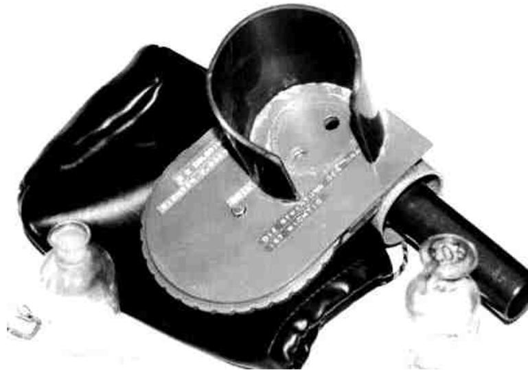
**Sauerstoffcolorimeter** (nach Richter und Päsler), auf der Jod-Stufe der Winckler-Methode
