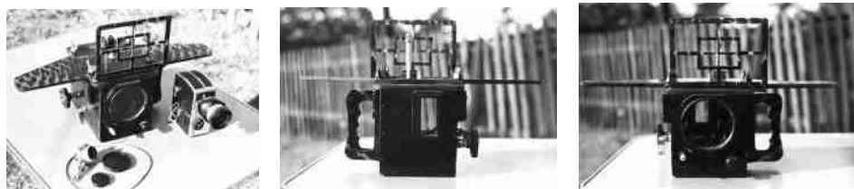
Unterwasser-Schmalfilmkamera Pentaka 8 mit UW-Gehäuse aus Celluloid
