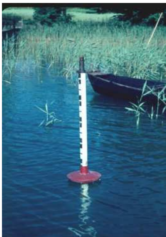
Der Wellenhöhenreiber vor der Station des MHD am Backofenberg
